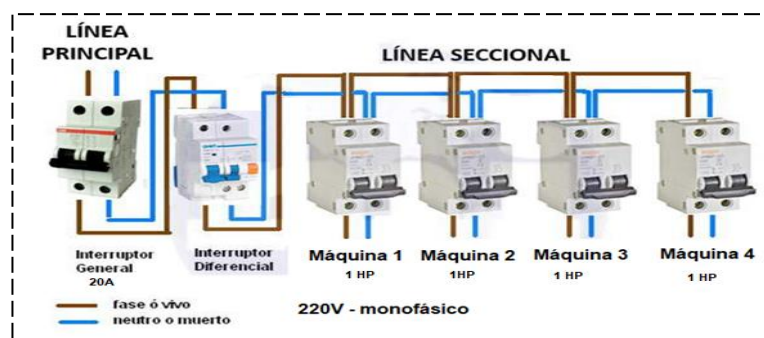
Figura 111. Instalación básica de máquinas monofásicas
